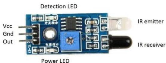
Gambar 1. Sensor Inframerah
