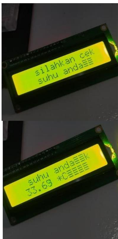
**Gambar 14. LCD Display ketika dalam keadaan stand by dan dalam keadaan sensor inframerah mendeteksi kedatangan pengguna**
