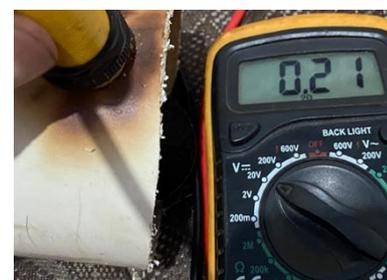
**Gambar 15.** Pengukuran tegangan *Proximity* Tidak mendeteksi
