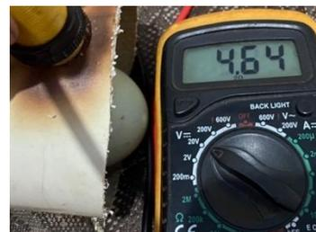
**Gambar 14.** Pengukuran tegangan *Proximity* Mendeteksi
