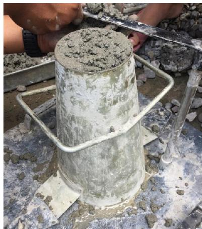
Gambar 6. Pengujian Slump
