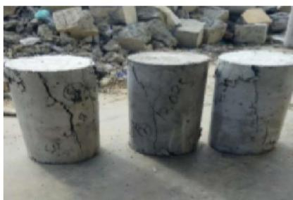
**Gambar 4. Pola Retak Beton Serat 5%**
