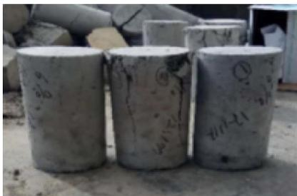
**Gambar 5. Pola Retak Beton Serat 6%**
