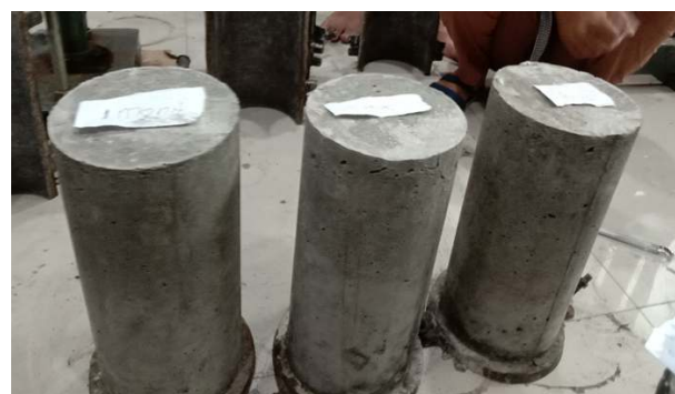
Gambar 2. Beton tanpa perawatan
