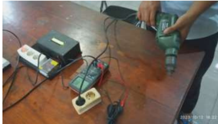
Gambar 6. Proses Pengujian Alat Koreksi Faktor Daya dengan beban handdrill
