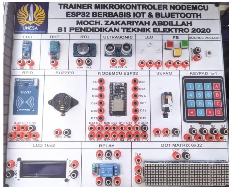
Gambar 5. Bagian Isi Komponen Pada Papan *Trainer* Mikrokontroler ESP32 Berbasis *Internet Of Things* dan *Bluetooth*
