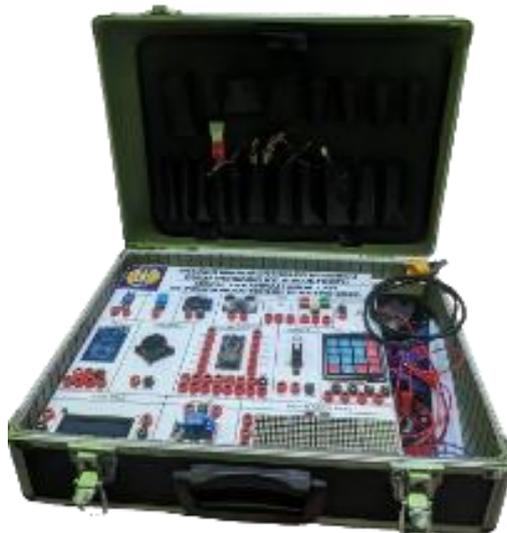
Gambar 4. Tampilan *trainer* Mikrokontroler NodeMCU ESP32 berbasis *internet of things* (IoT) dan *Bluetooth*
