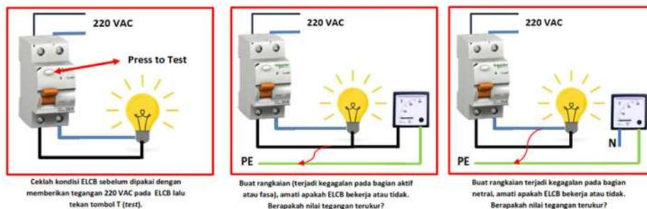
Gambar 16. Uji Coba Kondisi Fungsi Proteksi ELCB[16]
