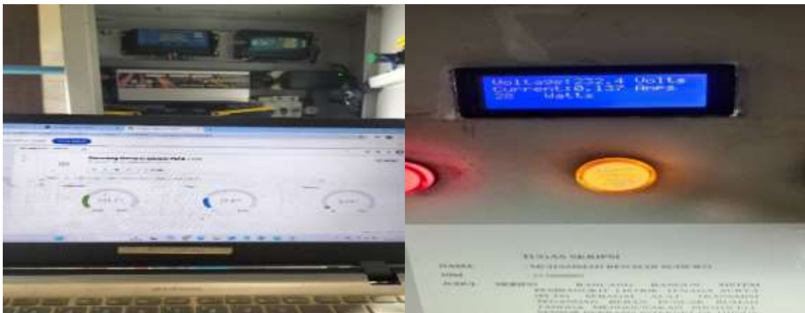
Gambar 10. Pengujian Output Daya Inverter Saat Beban Puncak Dengan Daya 28Watt Secara Langsung
