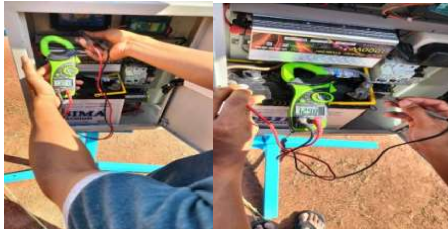
Gambar 9. Pengujian Output SCC dalam Pengisian Baterai Secara Langsung
