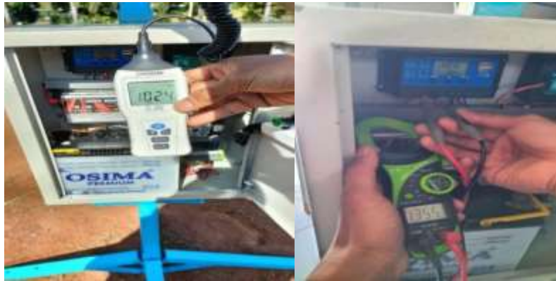
Gambar 7. Pengujian Output Daya yang dihasilkan Panel Surya secara langsung
