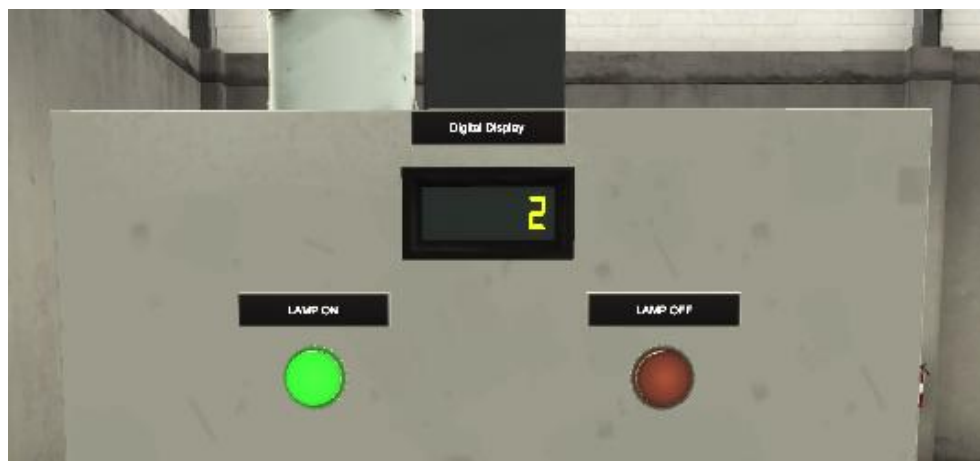
Gambar 16. Kondisi Digital Display Ketika Vision Sensor Mendeteksi Barang
