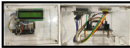
Gambar 11. Prototipe alat pengukur gula darah non-invasif yang dikembangkan.
