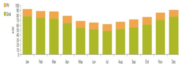
Gambar 6 Produksi listrik dari PV-Grid
