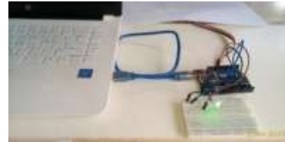
Gambar 4. Tes Mikrokontroler ATMEGA328P
