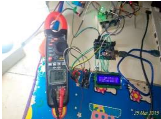
Gambar 10. Tes Sensor Arus ACS712
