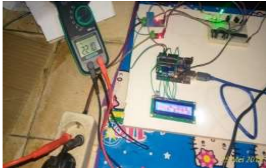
Gambar 12. Tes Sensor Tegangan ZMPT101B
