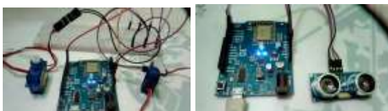
Gambar 2. Rangkaian wemos D1 dengan servo motor dan HC-SR04
