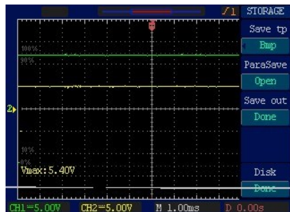
Gambar 14. Gambar Gelombang Output (grafik kuning) dan Input (grafik hijau) Rangkaian Regulator 5V
