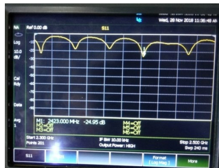
Gambar 6. Hasil pengukuran Return Loss
