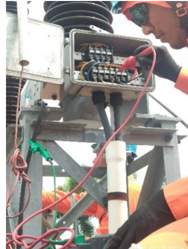
Gambar 3 Melakukan Pengujian Tahanan Isolasi
