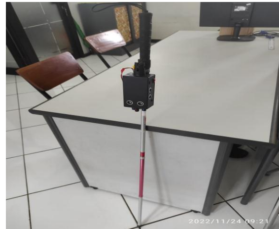
Gambar 11. Tongkat/Smartstick lengkap dari Aplikasi Arduino pada Smartstick bagi penyandang Tunanetra
