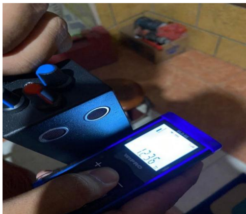
Gambar 6. Pengujian jarak pada Aplikasi Arduino pada Smartstick bagi penyandang Tunanetra
