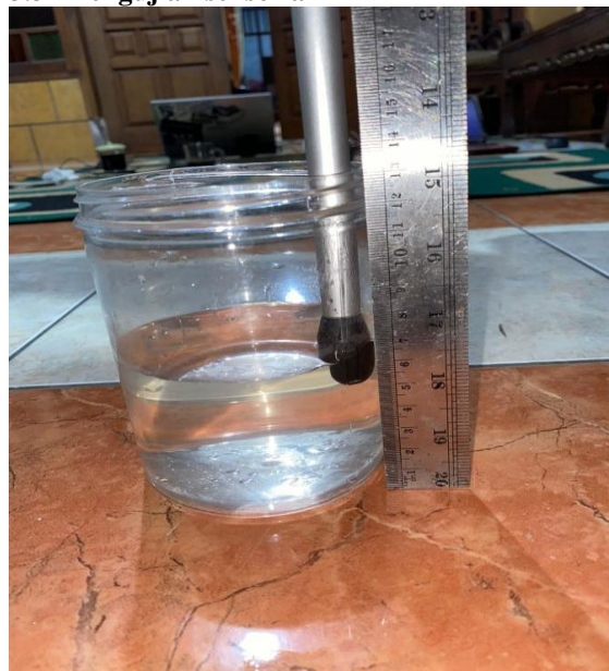
Gambar 8. Pengujian sensor air pada Aplikasi Arduino pada Smartstick bagi penyandang Tunanetra
