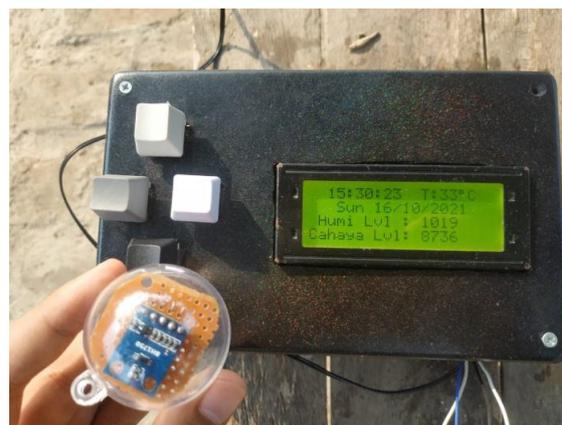
**Gambar 4 Sensor Intensitas Cahaya (GY-302) pada Alat**
