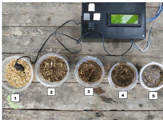
**Gambar 3. Sensor Soil Moisture pada Alat**
