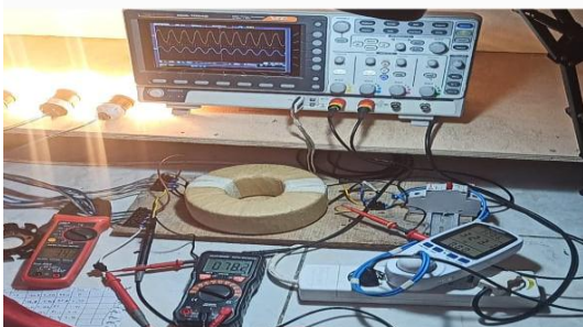
Gambar 4. Pengujian trafo toroid dengan menggunakan beban lampu pijar
