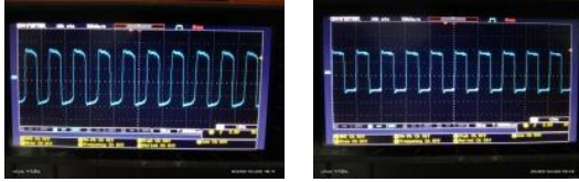
Gambar 7. Keluaran gelombang dengan beban 15 Watt dan 30 Watt
