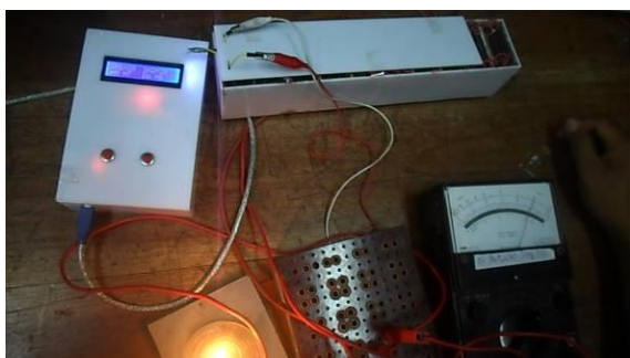
Gambar 5. Pengujian dengan lampu pijar dan mini panel
