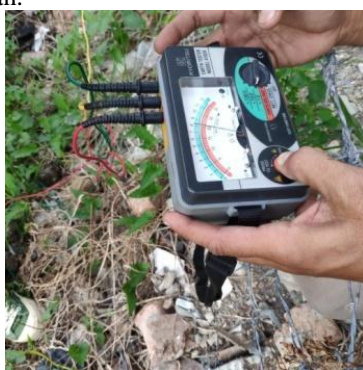
Gambar 2. Proses pengukuran nilai tahanan pentanahan.
