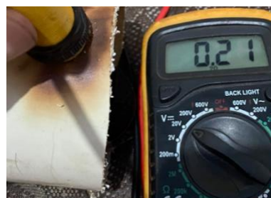
Gambar 3. 8 Pengukuran tegangan Proximity Tidak mendeteksi
