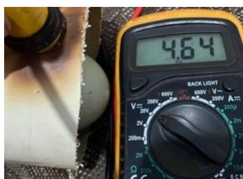
Gambar 3. 7 Pengukuran tegangan Proximity Mendeteksi
