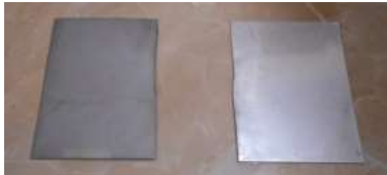
Gambar 1. Perubahan warna pada stainless steel setelah direndam dengan larutan HCl 30%.
