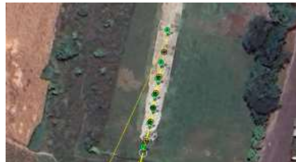
Gambar 6. Visualisasi rencana misi penerbangan ( flight plan ) pada antarmuka GCS yang menunjukkan penempatan waypoint secara linier melintasi area vegetasi.
